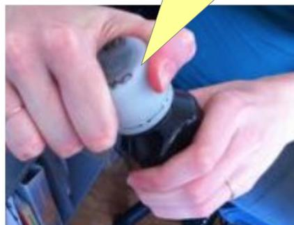
Visser le bouchon jusqu'à entendre le « **CLICK** » de la bague de sécurité
