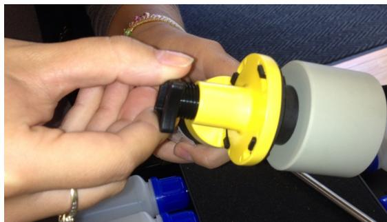
3. Insérer le flexible dans l'embout.
