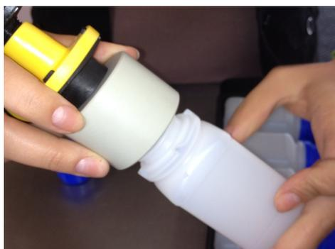
5. Insérer l'autre extrémité du flexible dans votre point de prélèvement. Si possible, au milieu du bain (ni au fond ni à la surface).
